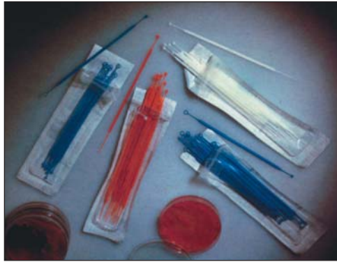
Полимерные специальные петли и иглы "QUADLOOP" с четырехгранной ручкой: Петли: петля + шарик, Иглы: игла + шарик.
