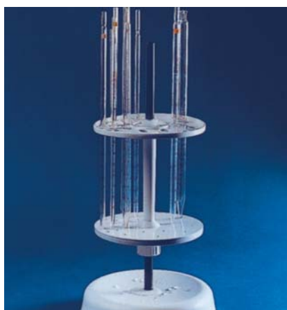
Подставка вертикальная "ВЕРТИКАЛЬ-КРУГ". Материал-полипропилен. Состоит из основания со стержнем и бабины, которую можно закрепить на необходимой высоте. Небольшие отверстия в основании обеспечивают дренаж. Вмещает 18 пипеток диаметром не более 10 мм и 10 пипеток диаметром не более 15 мм.
