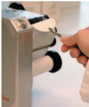
Извлечение стерильной мембраны из диспенсера
