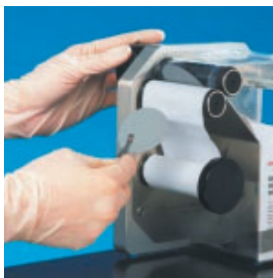
Ручной диспенсер для одиночных стерильных мембран
